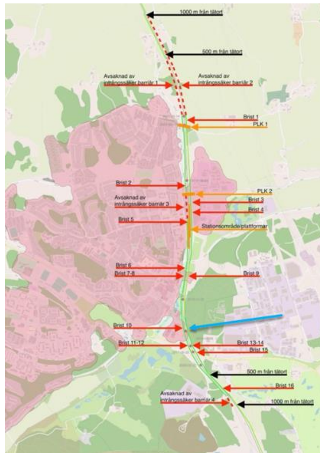
Figur 14. Inventering av Märsta tätort och 1000 meter utanför tätorten 2023-03-29. Totalt identifierades 16 brister i intrångsskyddet.
