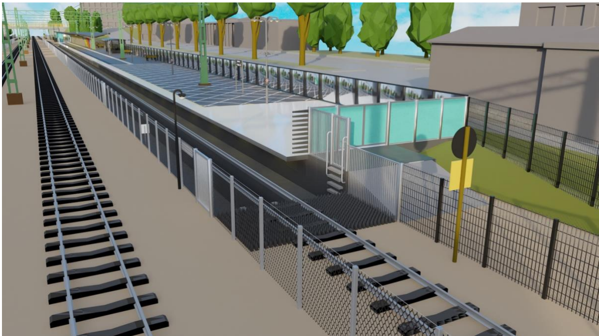
Figur 27. Plattformsände utan stationsutgång sedd från spårområdet. Plattformen slutar bakom hjältänderna. Uppmärksamma även att väggen på kortsidan inte är transparent så att det inte ska gå att se när tåget kommer och därigenom göra det svårare att förbereda ett suicidförsök. Uppmärksamma även att staketet är byggt så att det inte finns några platser där en person kan gömma sig. Behörig personal leds från den ramp som löper från plattformen ner till en grind i staketet in till spårområdet.
