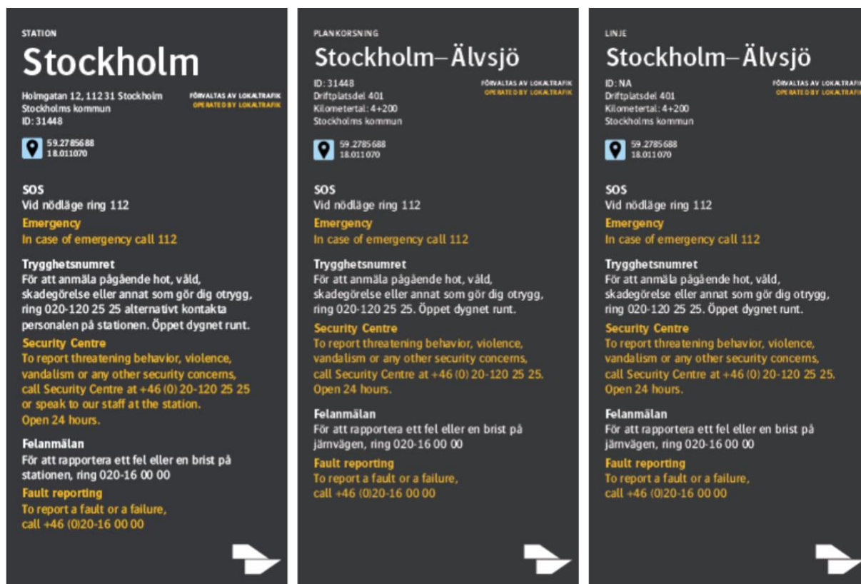
Figur 37. Enhetliga orienteringsskyltar som används vid stationer, plankorsningar och på "linjen" mellan stationer för att informera resenärer och allmänhet om hur de ska agera vid fara och fel på järnvägen.
