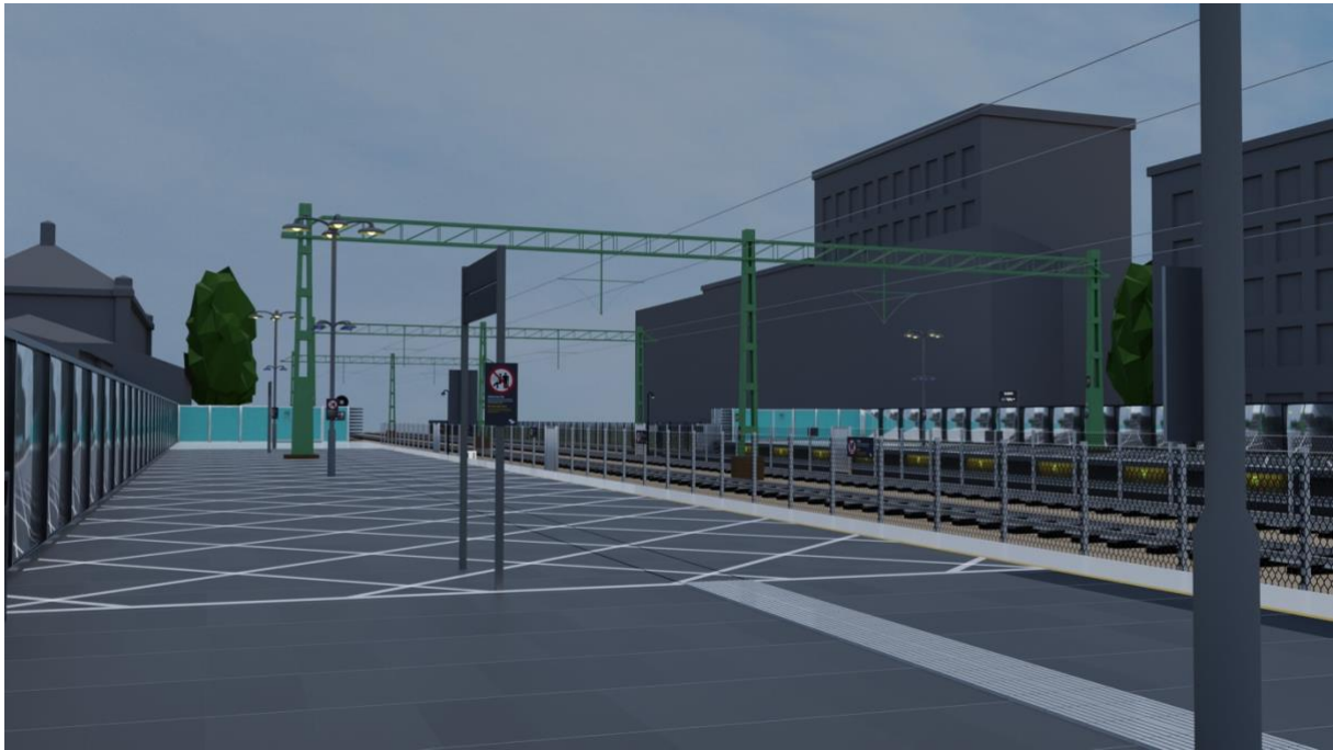
Figur 22. En "box junction" på plattformen som markerar var väntzonen på plattformen upphör. Inom detta område ska ingen väntan på ankommande tåg förekomma. Syftet är att öka den sociala kontrollen över plattformarna och innebär ytterligare en barriär för spårbeträdanden från plattformsändarna.. Detta område samt det vita området i plattformsändarna bör övervakas av sensorer (förslagsvis automatiserad videoanalys) så att ett riskabelt beteende kan avbrytas redan innan en person befinner sig på spårområdet. Det kan till exempel ske genom högtalarutrop eller belysningsåtgärder om någon beträder dessa ytor på ett avvikande sätt.
