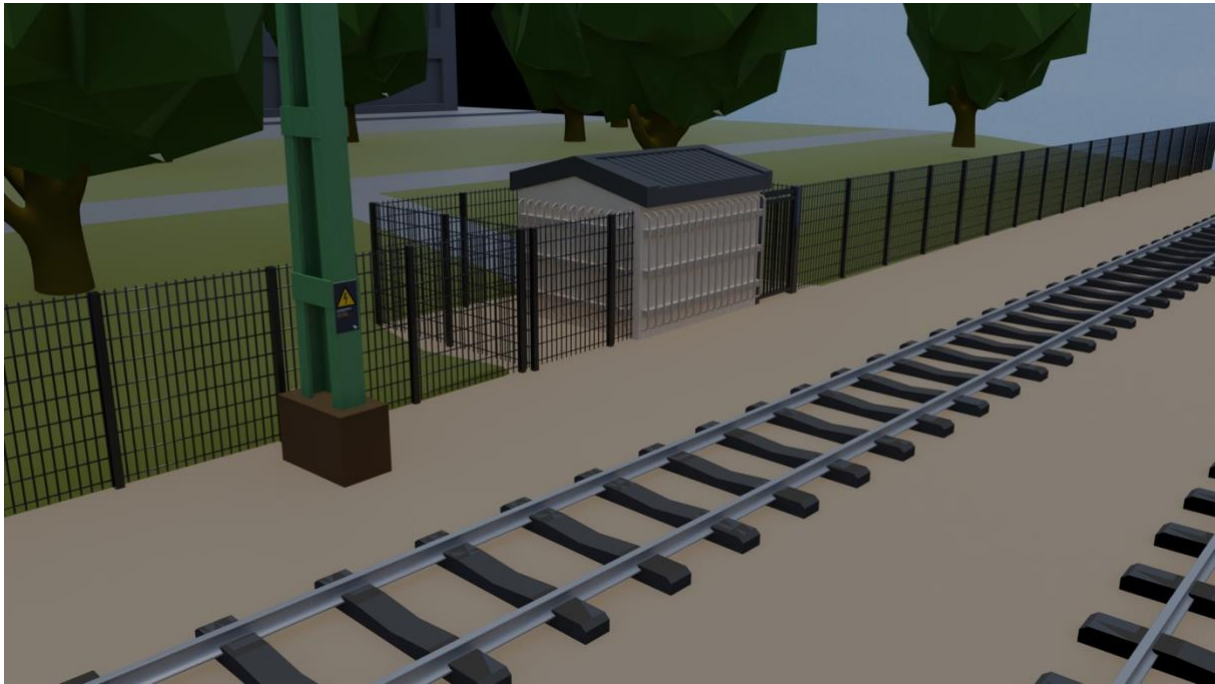
Figur 26. Stålnätspanelerna som ger intrångsskyddet är monterade så att man ej kan gömma sig bakom teknikhuset, och fria siktlinjer ökar den sociala kontrollen över spårområdet. På väggen är en "anti-klotter-spaljé" monterad. Uppmärksamma att kontaktledningsstolpar som står på spårområdet ej behöver ha klättringsskydd.
