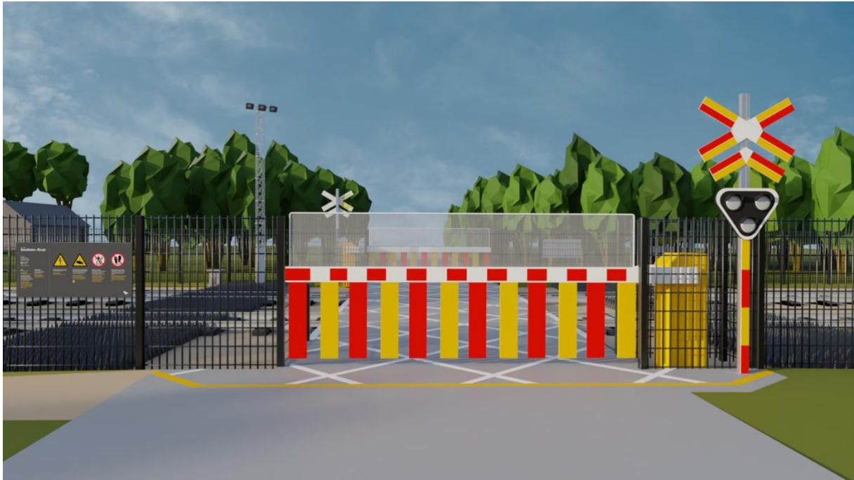
Figur 33. Standardbom med bomkjol och påbyggd ovanhel i ett icke elektriskt ledande material. Den intrångssäkra barriären (staketet) runt plankorsningen sluter tätt mot bommen och bomdrivet så att det inte finns något hål i barriären.
