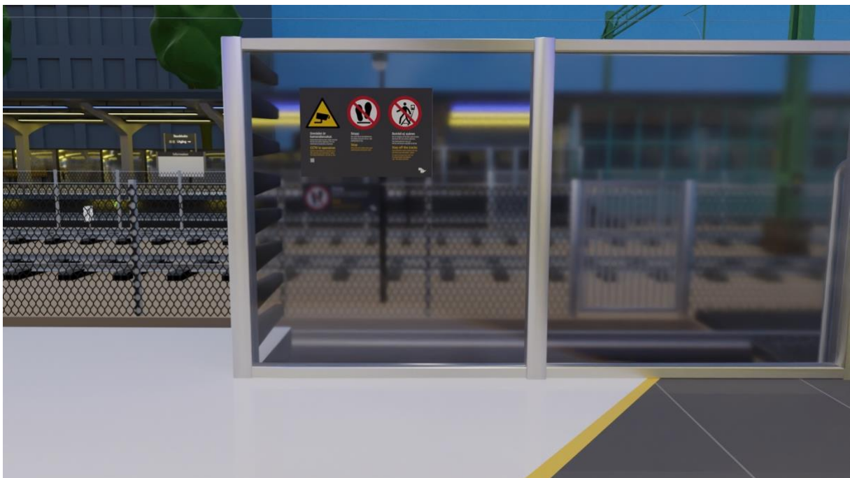
Figur 15. Förstärkt säkerhetskommunikation som består av en utökad vit linje i plattformssänden, tydliggjord med en gul linje och tillhörande skylt som anger att den gula linjen endast får passeras vid av- och påstigning av tåg. I den plattformssände där det finns en stationsutgång sitter en transparent barriär som minskar risken för obehöriga spårbeträdanden ut i spårområdet. 43
