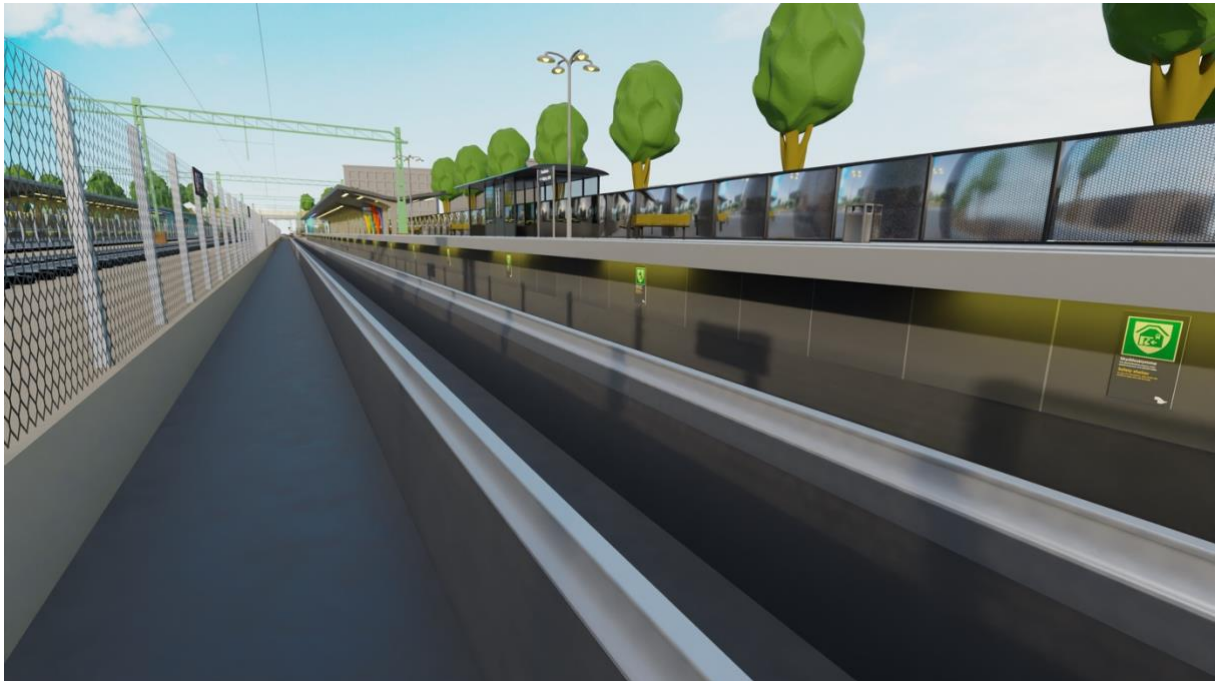
Figur 28. Närbild på diken mellan farskenor och skyddsutrymme under plattformskanten. Botten på diket är inklätt i stötdämpande material, vilket minskar skadeverkan vid fall ner på spårområdet. Plattformen bör byggas med en kant med underliggande skyddsutrymme för evakuering vid nödsituationer. Under plattformskanten sitter även skyltar som informerar om detta. Lampor som belyser skyltarna tänds då ett spårbeträdande detekteras.
