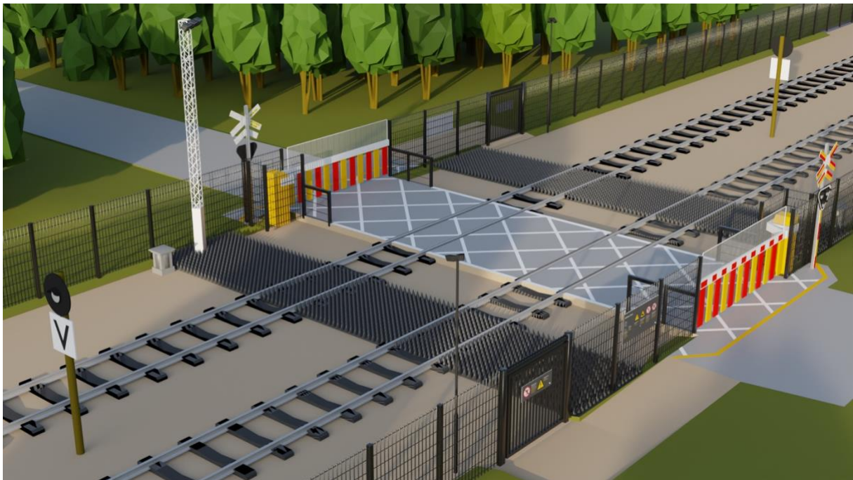
Figur 34. På ömse sidor om vägen monteras pyramidmattor cirka fem meter in på spårområdet. Anledningen till att de inte ligger jämte vägen är därför att avståndet skapar en förväntan om att de är svåra att gå på, vilket hade varit möjligt att enklare testa om de legat jämte "tillåtet" område. Denna förväntan bedömer vi förstärker avhållande effekten pyramidmattorna kan ge. Direkt bortom och på ömse sidor om pyramidmattorna är hinderdetektorer placerade. Det finns även av en mast med monterad allmänbelysning och högtalare för respons om någon av sensorerna upptäcker ett intrång.
